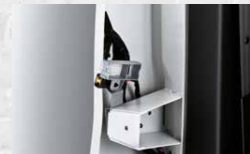
PRESA TRASFORMATORI - INTERFACCIA ELETTRICA PER CONNETTERE LE UTENZE DELL'ALLESTIMENTO (OPT. 081)
