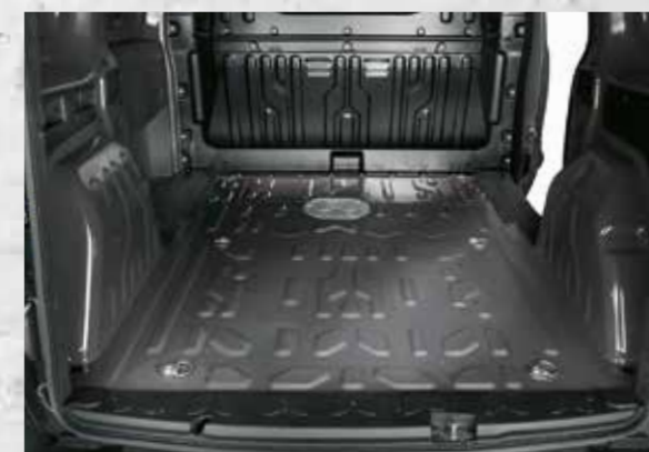
Rivestimento vano di carico
