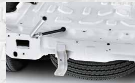
RUOTA DI SCORTA ACCESSIBILE DAL POSTERIORE E COMPATIBILE CON LA MAGGIOR PARTE DEGLI ALLESTIMENTI (OPT. 980)
