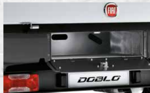
VANO ESTERNO PORTAOGGETTI CON SERRATURA PER RIPORE ATTREZZI FINO A 2 METRI DI LUNGHEZZA
